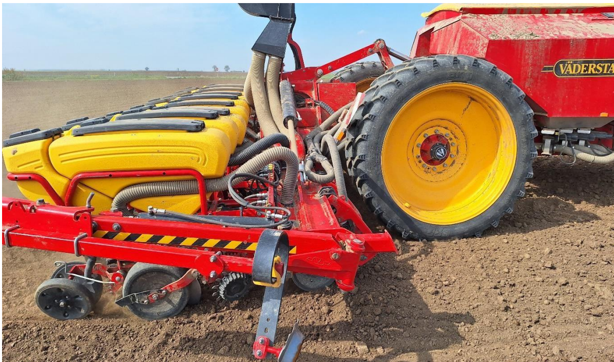
Slika 4. Sjetvena sekcija sijačice Tempo L 8 u radu
