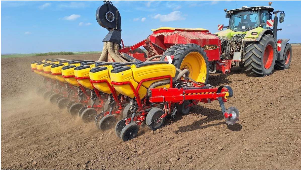
Slika 3. Vučena podtlačna sijačica Tempo L 8 u radu
