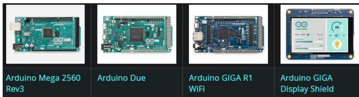
Slika 5. Arduino pločice iz obitelji Mega
