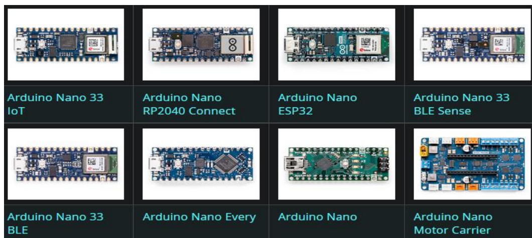
Slika 2. Arduino pločice iz obitelji Nano (Izvor: https://www.arduino.cc/en/hardware )
