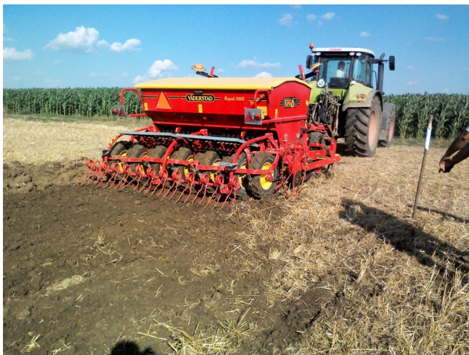
Slika 12. Sjetva sudanske trave „no-till“ sijačicom.
