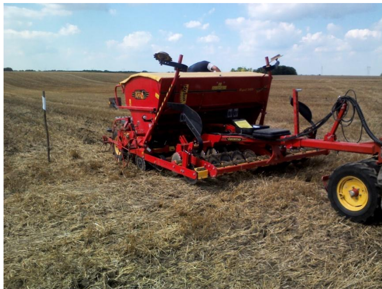
Slika 18. Rapid sijačica u postrnoj sjetvi sudanske trave.
