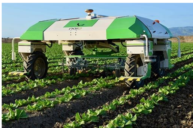
Slika 10. Robot Dino u kultivaciji salate
