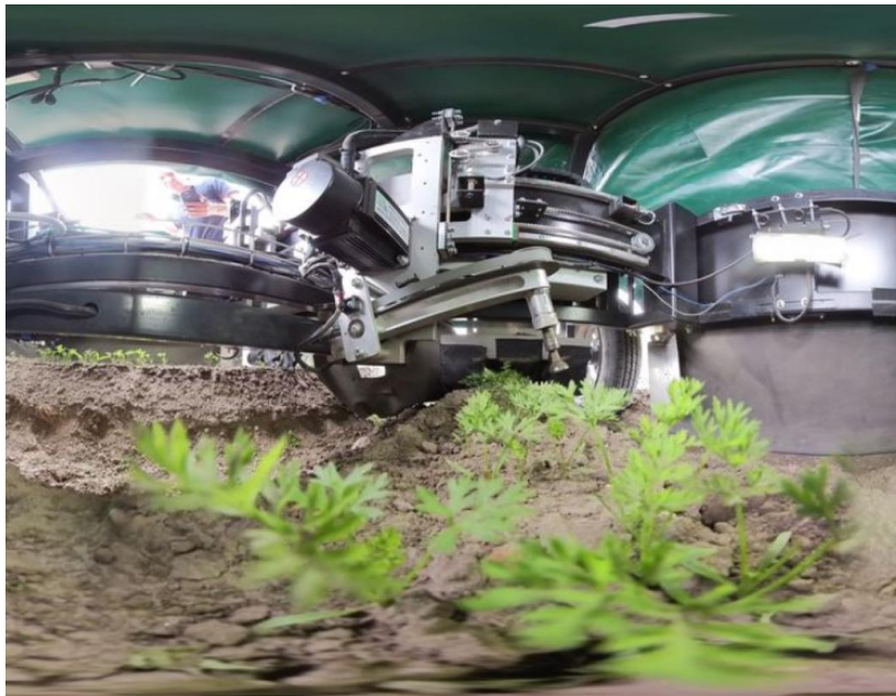
Slika 16. Radni organ „bušilica“
