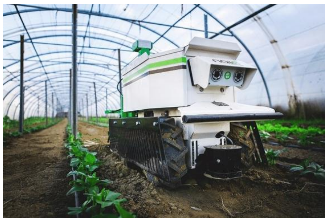
Slika 8. Robot Oz u kultivaciji (Izvor: Törtei, 2016.)
