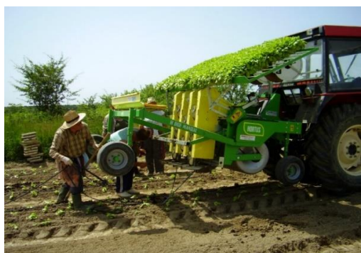
Slika 6. Mehanizirana sadnja zelene salate
