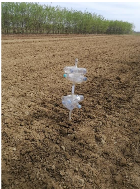
Slika 3 – Mjerna stanica za skupljanje lebdećih čestica
