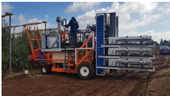
Slika 24. Fresh Fruit robot (Izvor: Agromillora, 2022.)
