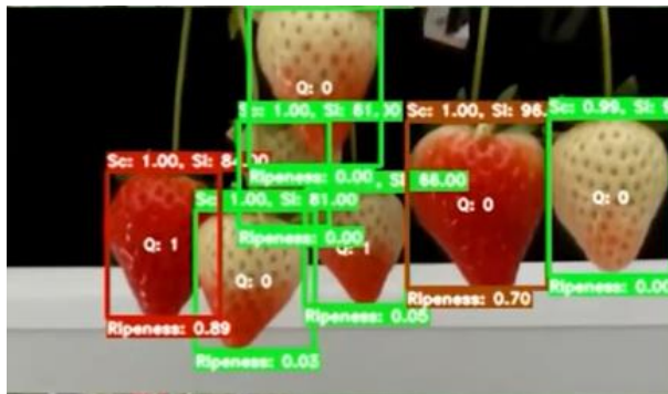
Slika 21. Prikaz prepoznavanja plodova na robotu BERRY (Izvor: Organifarms, 2022.)
