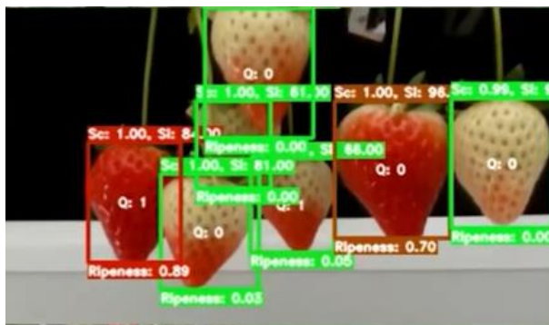
Slika 21. Prikaz prepoznavanja plodova na robotu BERRY (Izvor: Organifarms, 2022.)
