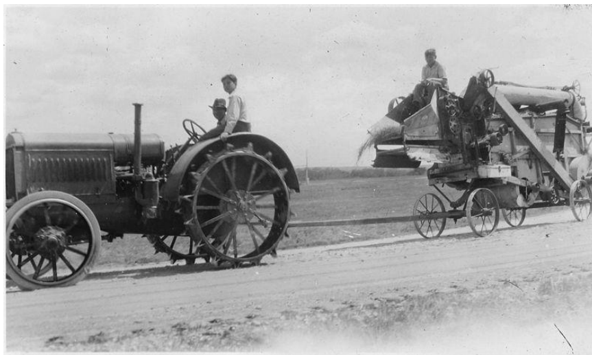
Slika 3. International Harvesterov prvi kombajn vučen traktorom, 1915.
