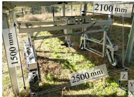
Slika 26. Dimenzije robota SynRobo (Izvor: Waseda University, 2023.)
