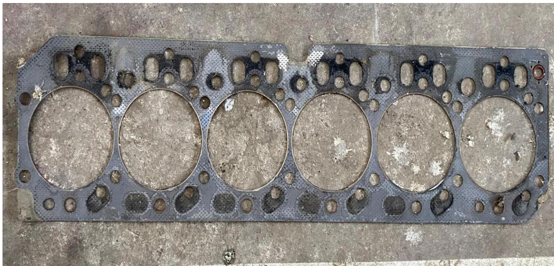
Slika 13. Neispravna brtva glave motora
