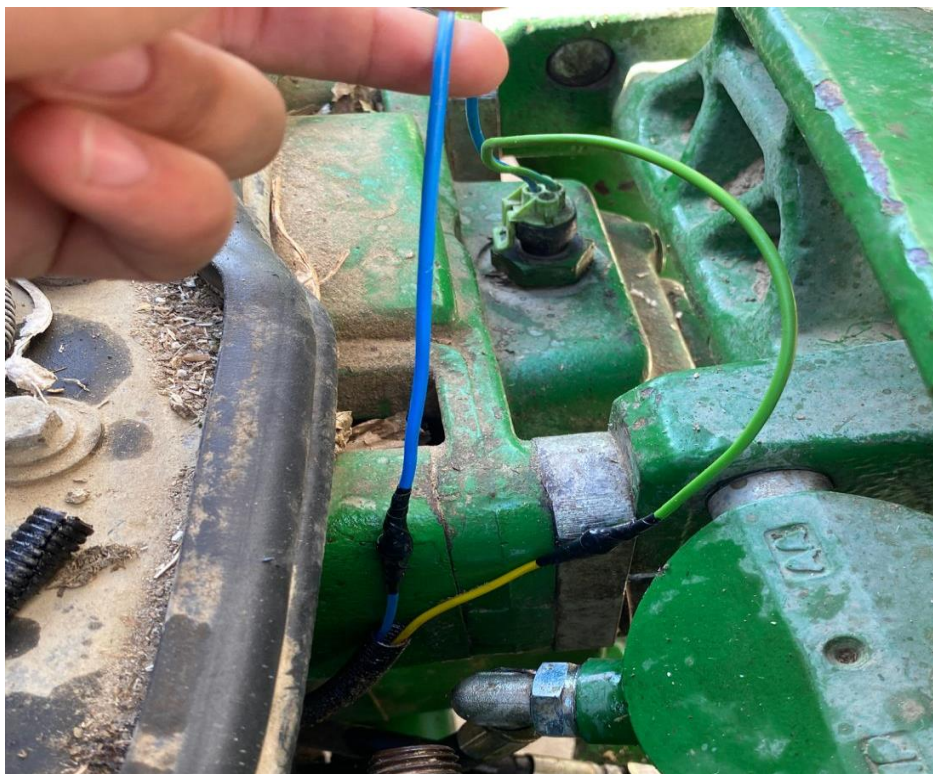
Slika 9. Oštećenost električne instalacije priključnog vratila
