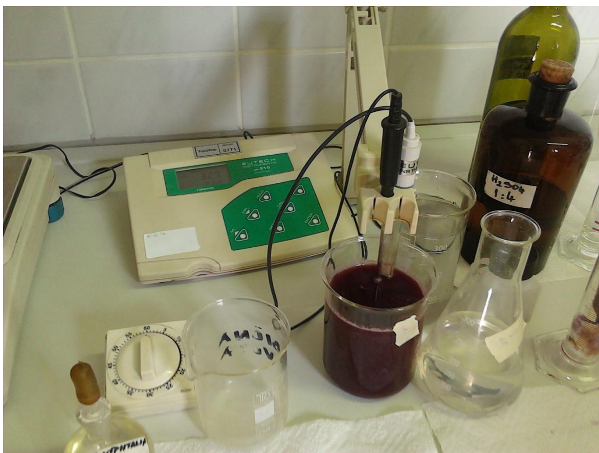
Slika 17. Mjerenje pH u moštu (Autor, 2013.)
