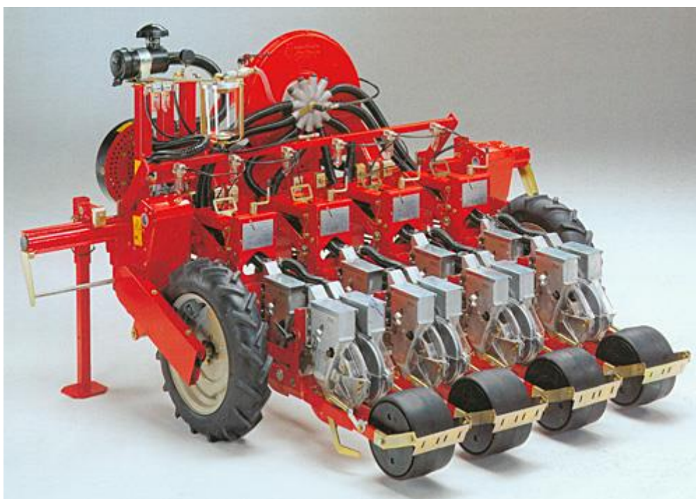
Sl. 19. Pneumatska sijačica sitnog sjemena, [19]
