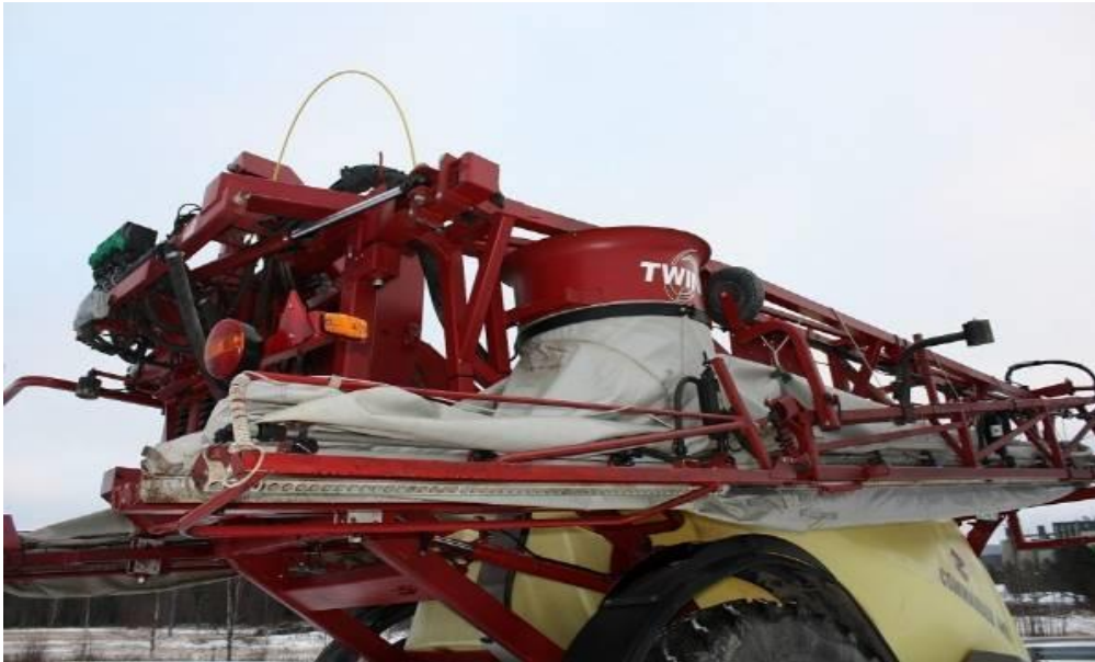
Sl.15. Prskalica za zračnom potporom, [15
