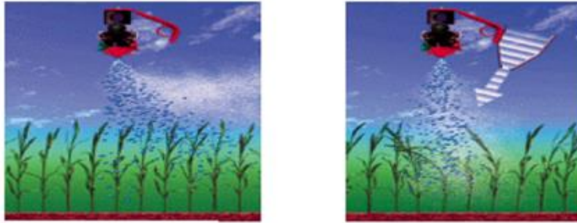
Sl.14. Razlika između konvencionalne prskalice i prskalice s zračnom potporom, [14]
