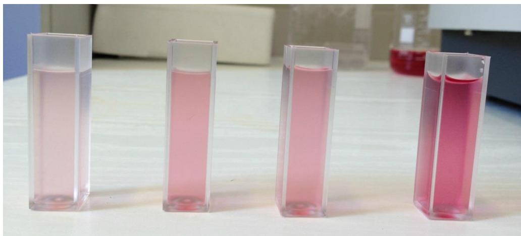
Slika 5. Uzorak s GOPOD-om u kivetama pripremljen za mjerjenje apsorbancije (foto original; N. Weg)
