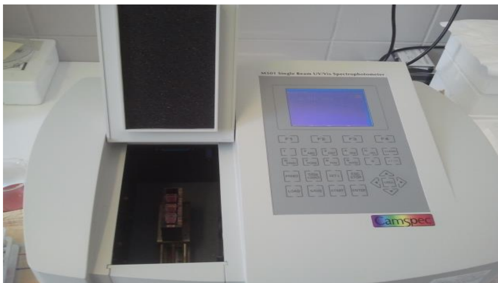
Slika 6. Uzorci u spektrofotometru Camspec M501 (jednozračni UV / VIS spektrofotometar) (foto original; N. Weg)
