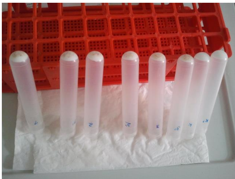
Slika 3. Talog škroba i cijedenje etanola (foto original; N. Weg)
