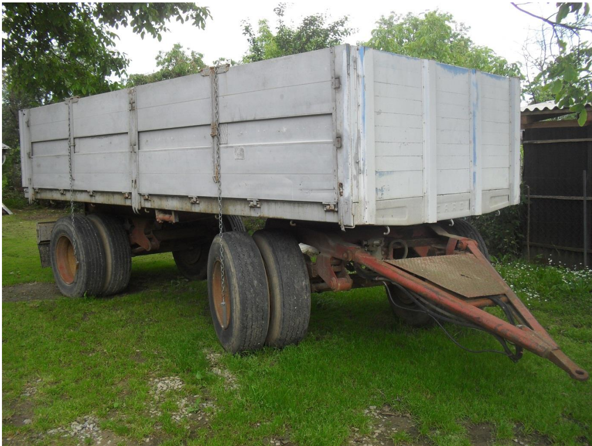
Slika 15. Prikolica „Cardi“, nosivost 10 t (Izvor: Vlastita fotografija)
