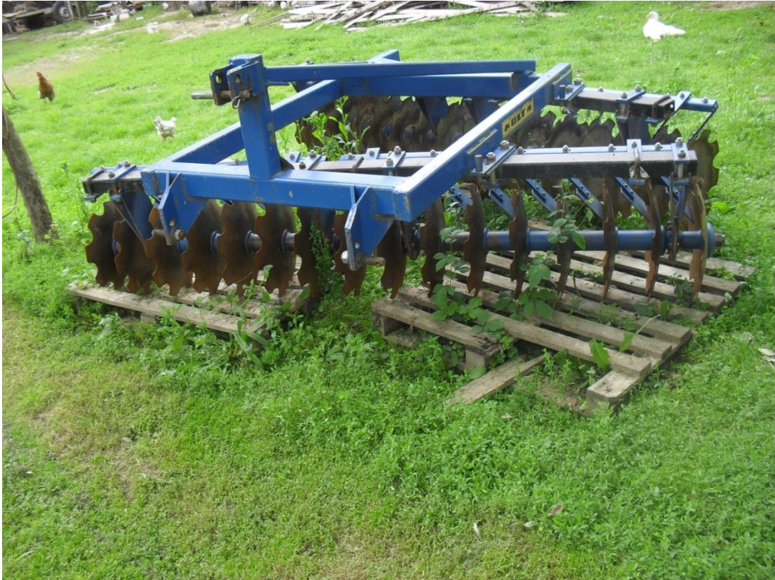
Slika 8. Tanjurača „Olt“ (Izvor: Vlastita fotografija)
