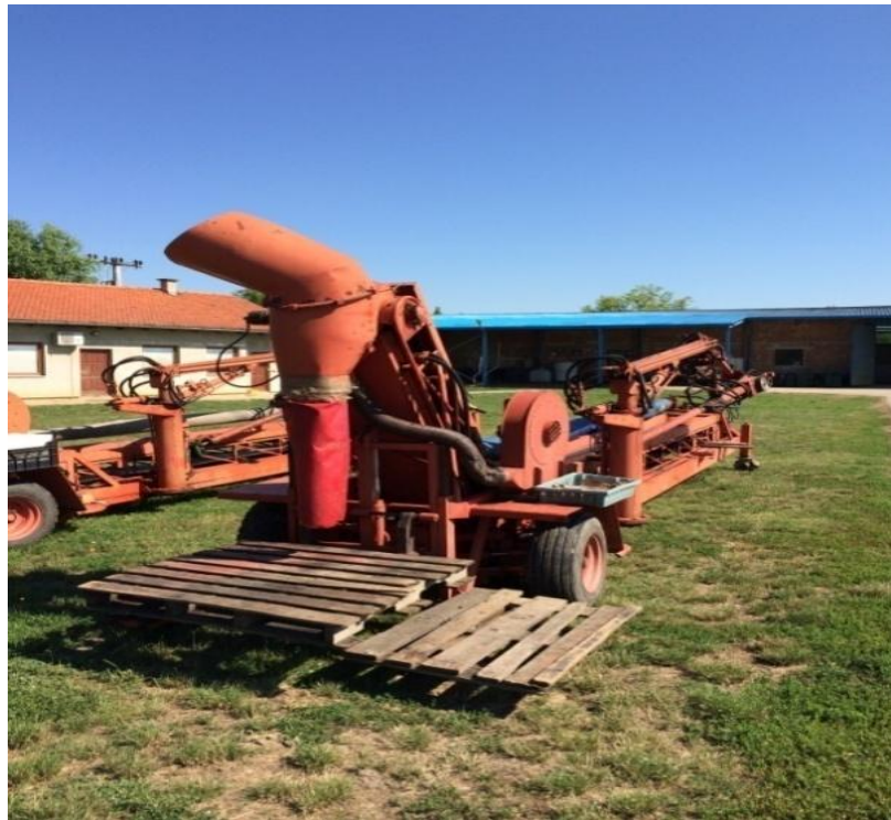
Slika 7. Vibracijski tresač „Skip“
