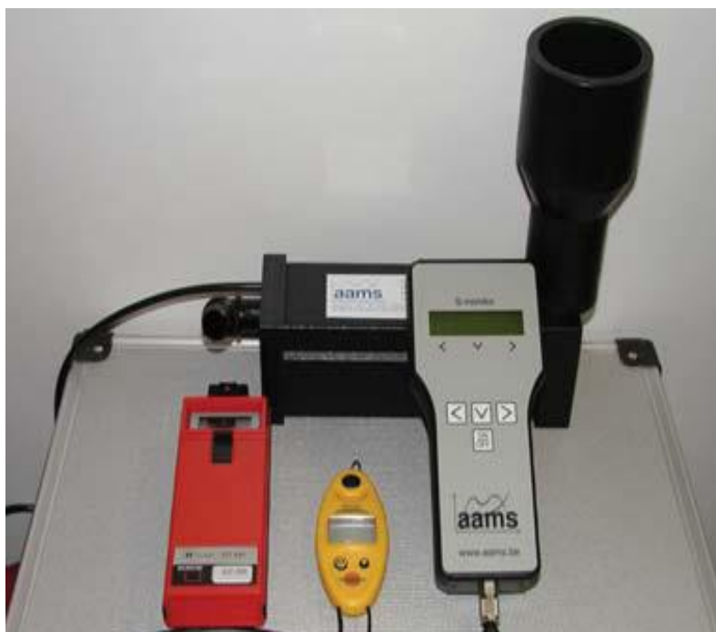
Slika 8. Uređaj AAMS za mjerenje protoka mlaznica (izvor Banaj) (izvor: arhiva Đuro Banaj )
