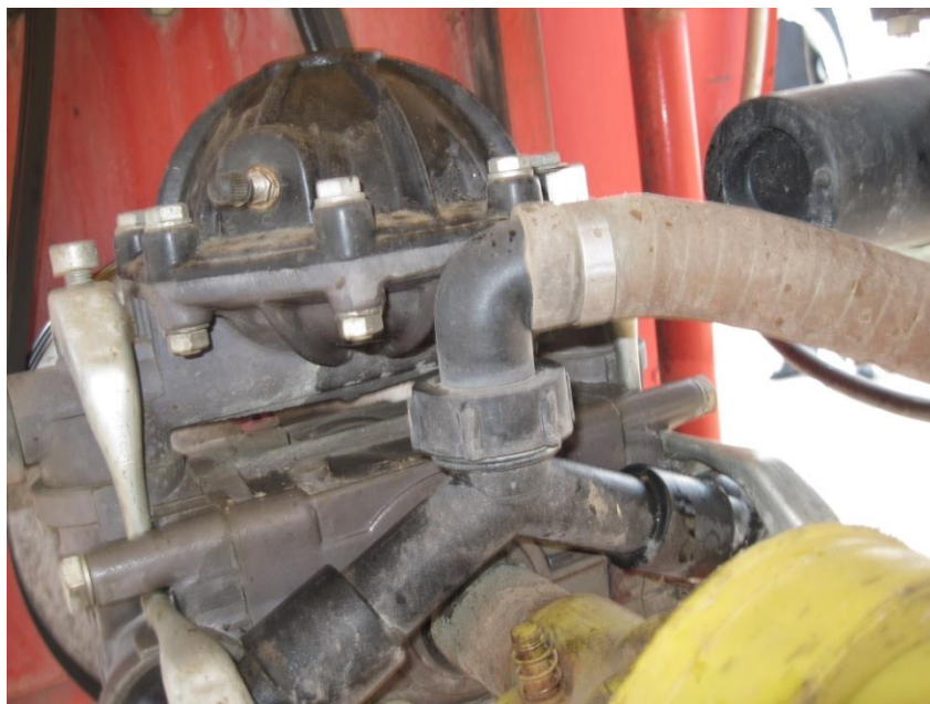
Slika 2. Klipno-membranska crpka AGROMEHANIKA – Model BM 65/30 (izvor: arhiva Đuro Banaj)
