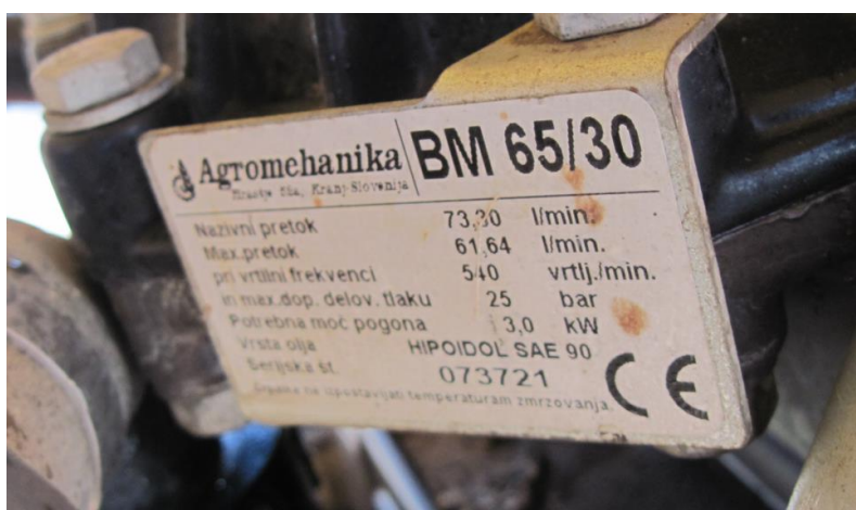
Slika 3. Pločica proizvođača na klipno-membranskoj crpki (izvor: arhiva Đuro Banaj)
