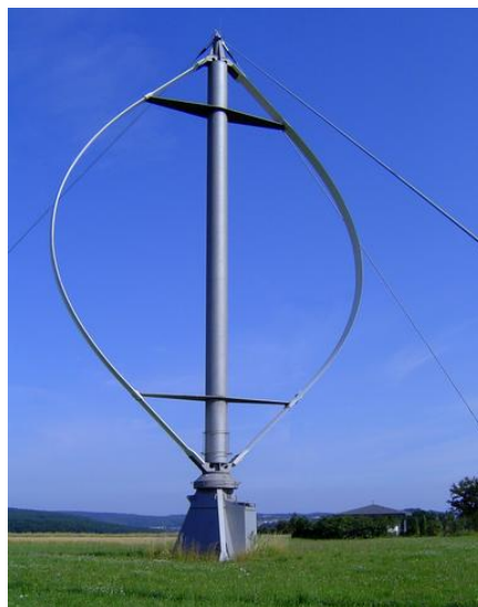
Slika 11. : Primjer VE s vertikalnom osovinom
