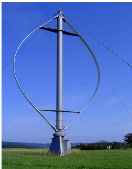
Slika 11. : Primjer VE s vertikalnom osovinom
