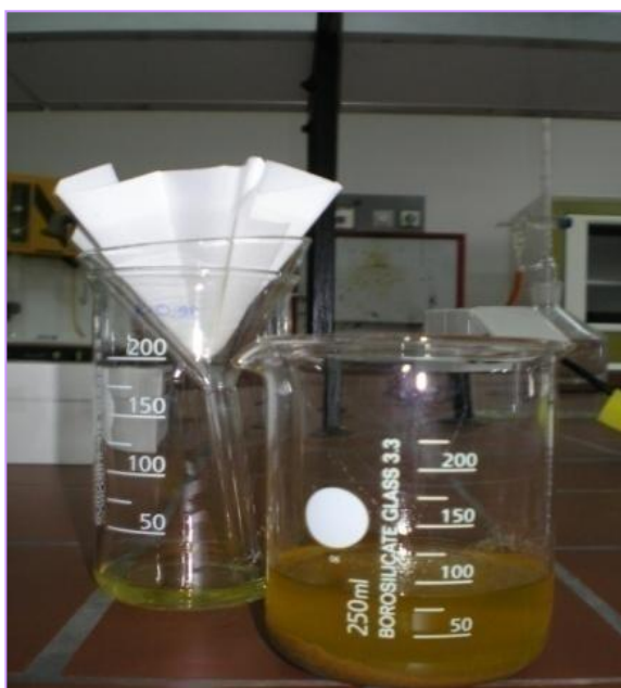
Slika 9: Analiza mikotoksina: ekstrakcija iz uzorka (Izvor: G. Kanižai Šarić)
