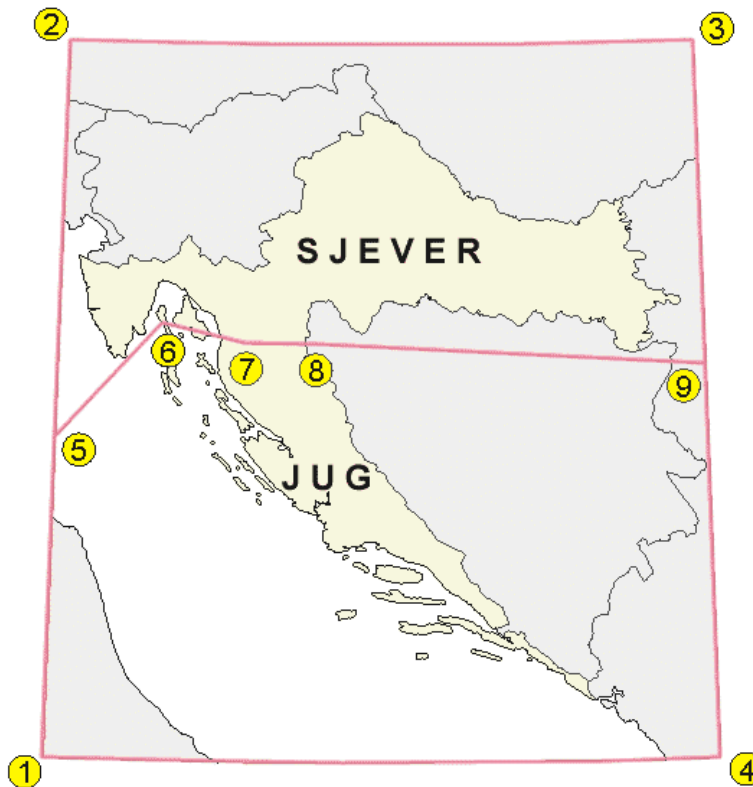
Slika 26.: Područje s različitim parametrima transformacije između Besselovog i WGS84 elipsoida
