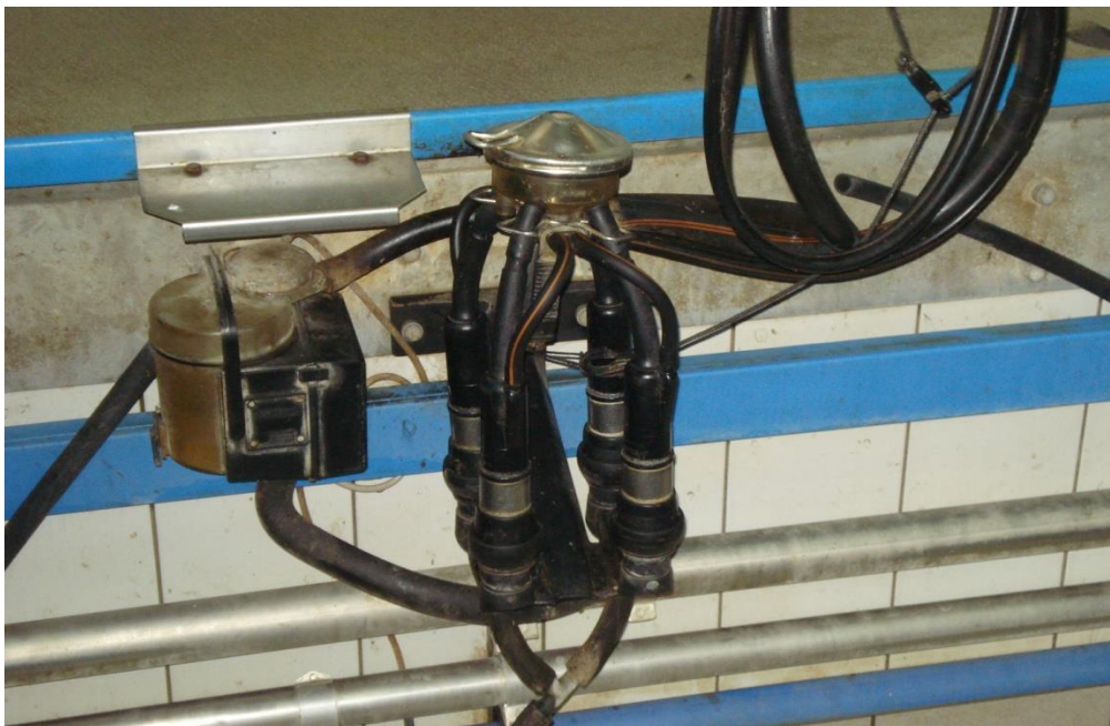
Slika 1. Pulzator na „farmi Tokić“
