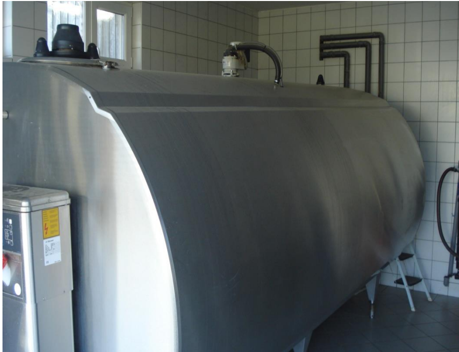
Slika 2. Rashladni spremnik na „Farma Tokić“ kapaciteta 10 000 litara
