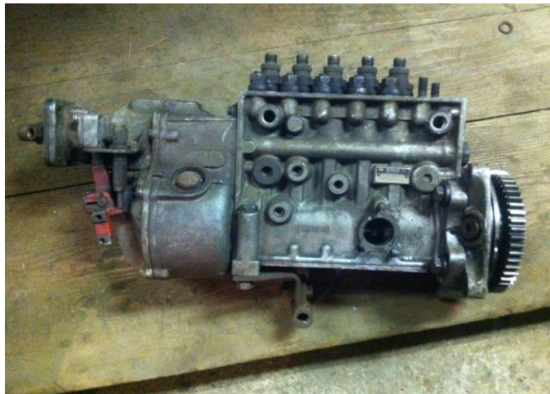
Slika 11. Visokotlačna klipna redna crpka marke „Bosch“
