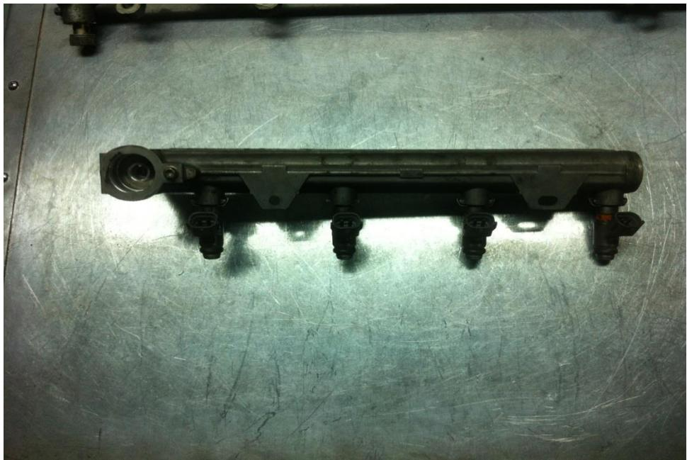
Slika 15. Visokotlačna cijev
