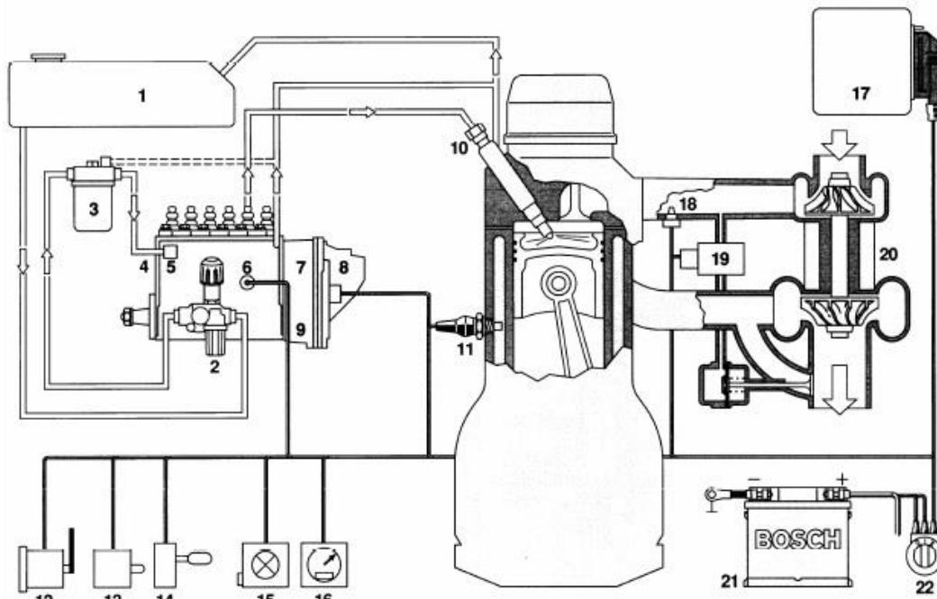
Slika 12. EDC upravljana redna klipna visokotlačna crpka
