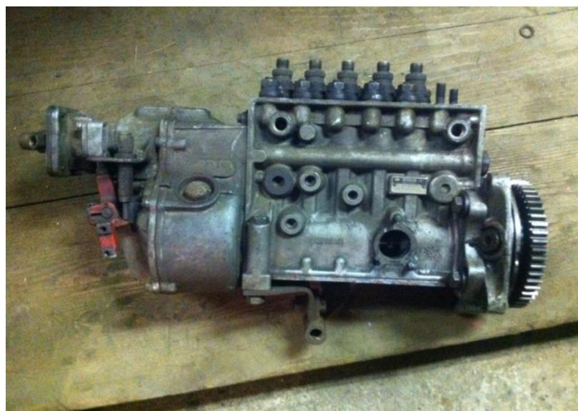
Slika 11. Visokotlačna klipna redna crpka marke „Bosch“
