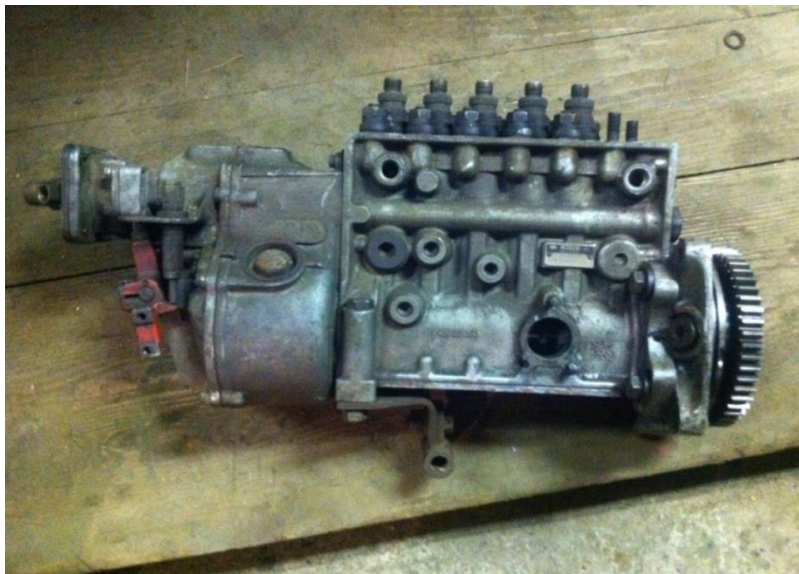
Slika 11. Visokotlačna klipna redna crpka marke „Bosch“
