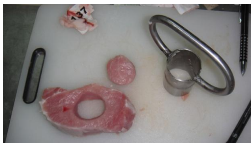
Slika 4. Prikaz mjerenja otpuštanja mesnog soka „metodom vrećice”
