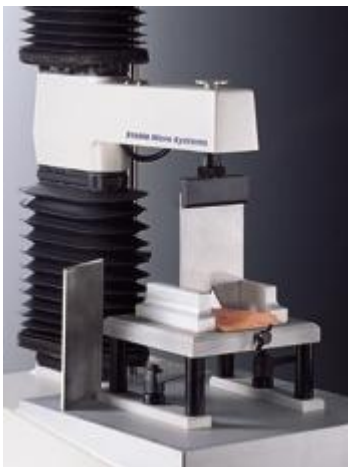
Slika 7. TA.XT Analyser sa priključenim Warner-Bratzler nožem
