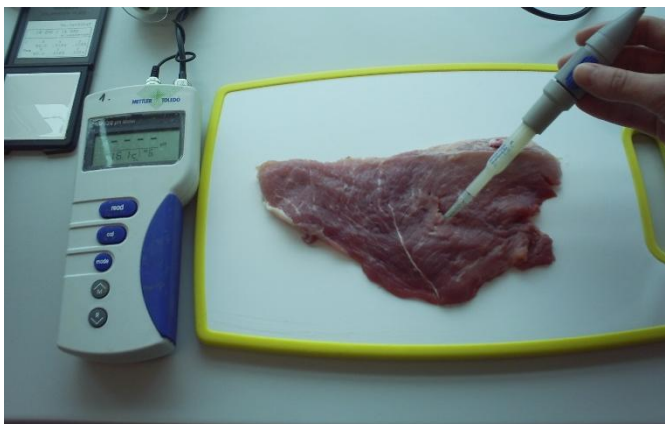
Slika 3. Mjerenje pH na m.semimembranosus
