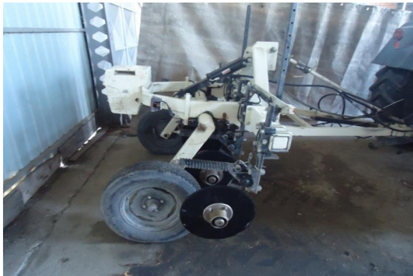
Slika 3. Mehanički skener tla.
