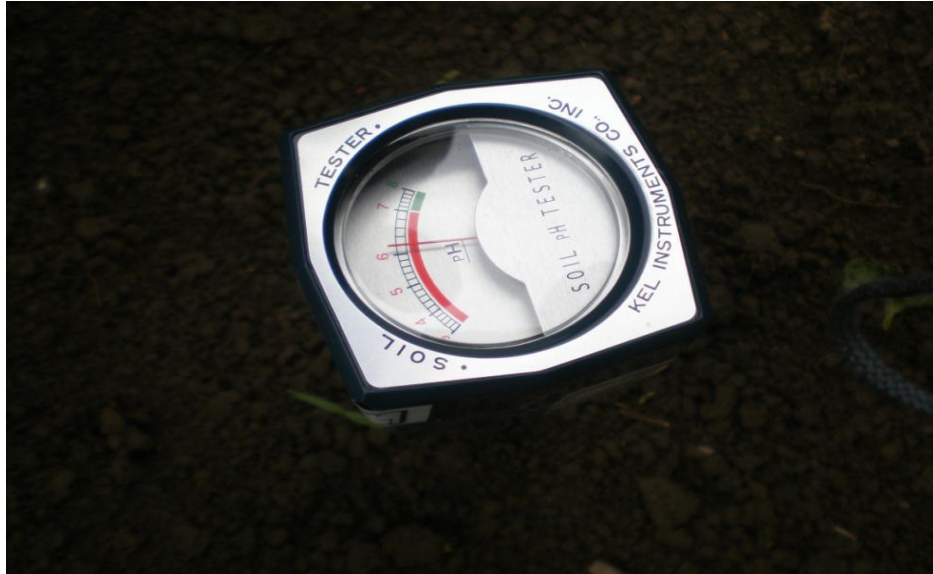
Slika 6: ph-metar za određivanje kiselosti tla (izvor;www: Kelway.com)
