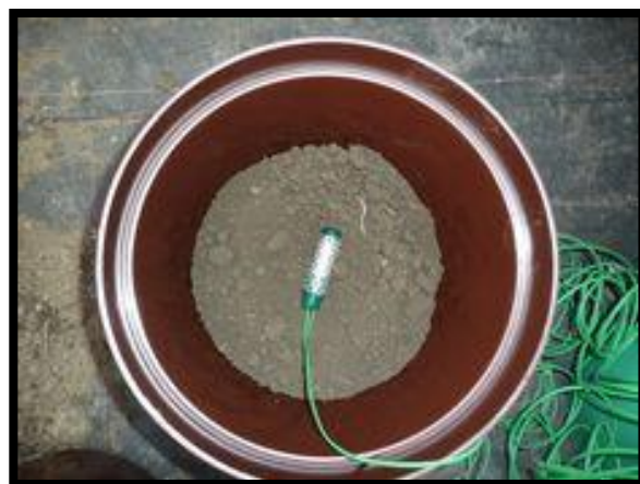
Slika 5. Uređaj Watermark – soil moisture sensor Slika 6. Postavljanje sonde u pokusne lonce
