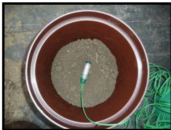
Slika 6. Postavljanje sonde u pokusne lonce
