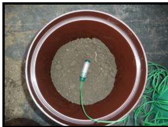
Slika 5. Uređaj Watermark – soil moisture sensor Slika 6. Postavljanje sonde u pokusne lonce
