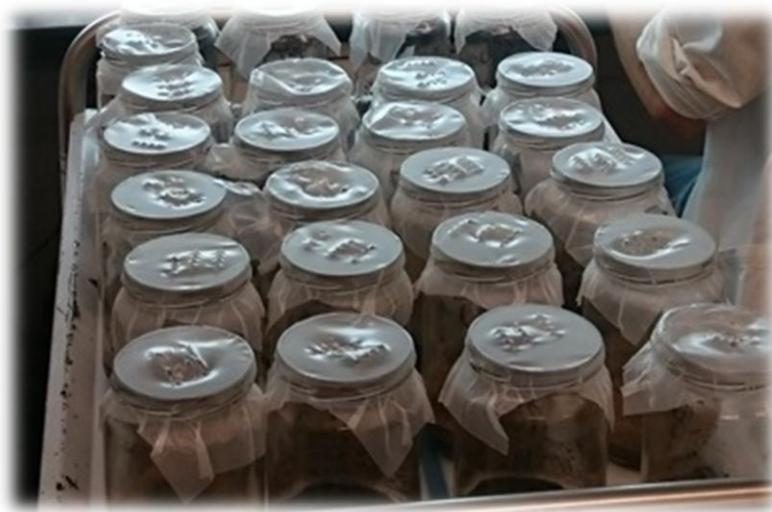
Slika 9. Aerobna inkubacija (originalna fotografija)
