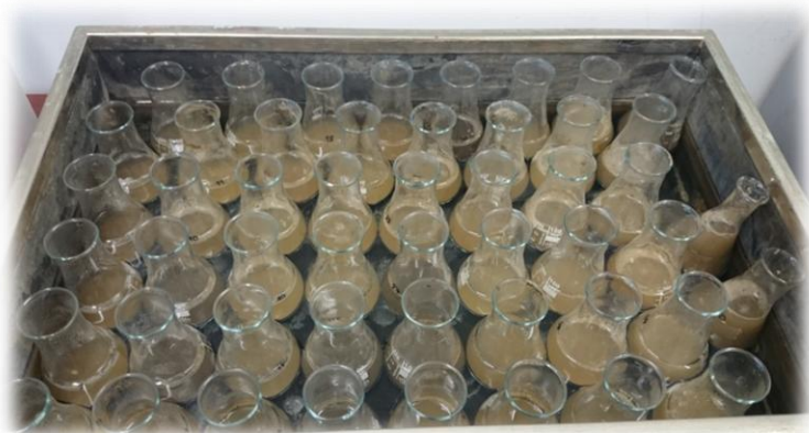
Slika 6. Vruća ekstrakcija s KCl-om (originalna fotografija)
