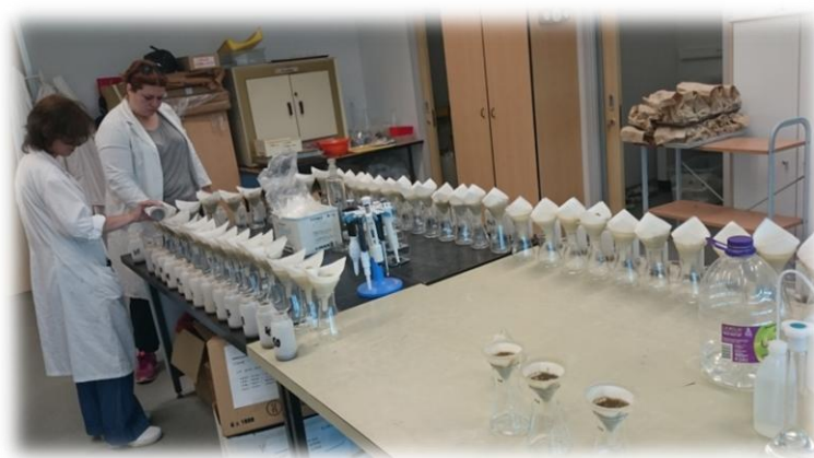
Slika 5. Nmin metoda (originalna fotografija)
