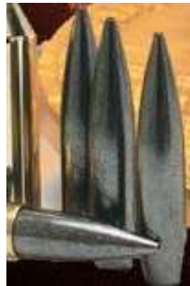
Slika 8. Moly premaz zrna ( www.norma.com )
