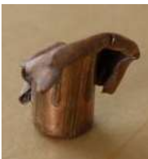
Slika 72. Winchester Silvertip zrno nakon prolaska kroz tijelo divljači (foto: D. Podlesak)
