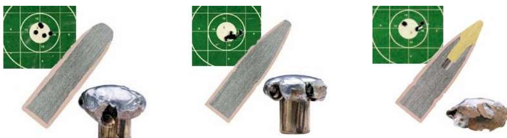
Slika 10. Zrno s blokiranom košuljicom mekog vrha
