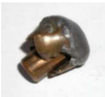
Slika 70. Zrno „Federal - Trophy bonded“ (foto: D. Podlesak)
