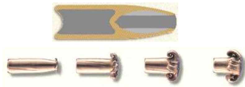
Slika 27. CDP zrno i tijekom deformacije pri udaru u tijelo divljači (izvor: www.blaser.com )
