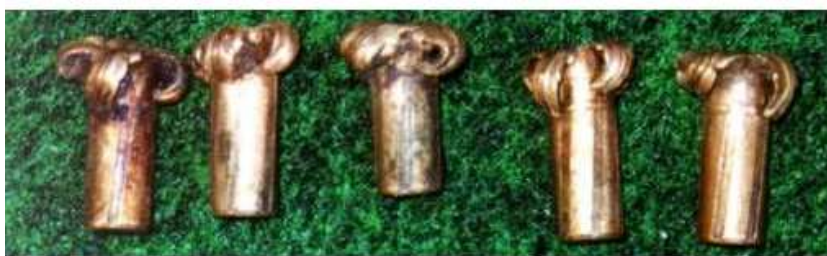
Slika 68. Barnes X zrno nakon prolaska kroz tijelo divljači (foto: D. Podlesak)
