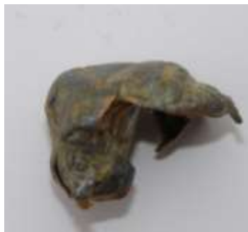
Slika 77. RWS Evolution zrno – košuljica i olovna jezgra čvrsto povezani (foto: D. Podlesak)
