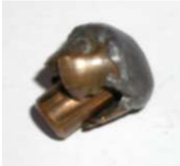
Slika 70. Zrno „Federal - Trophy bonded“ (foto: D. Podlesak)
