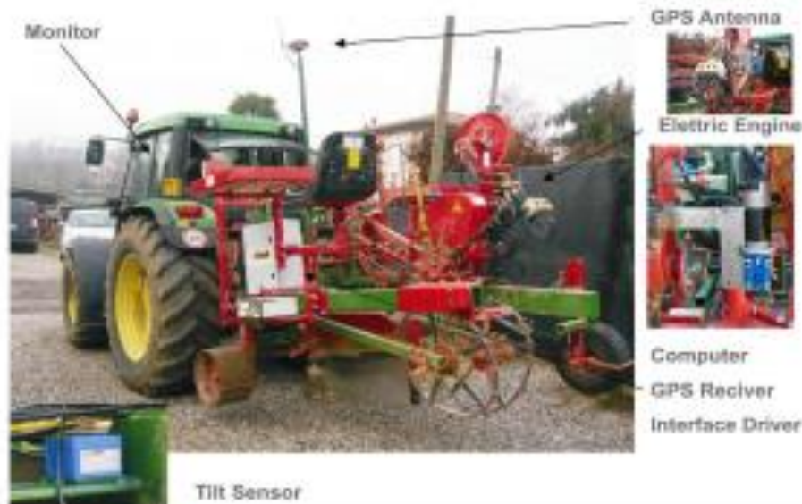
Slika 45. Komponente GPS sustava za navođenje
