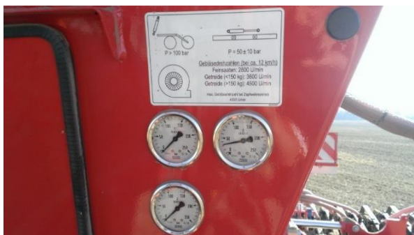
Slika 15. Instrumenti za očitavanje veličina rada ventilatora
