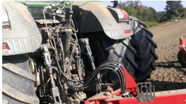
Slika 13. Prikopčavanje traktora i sijačice
