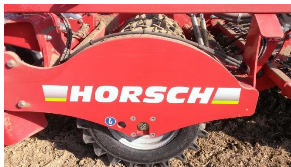
Slika 19. Paker valjak s pneumaticima
