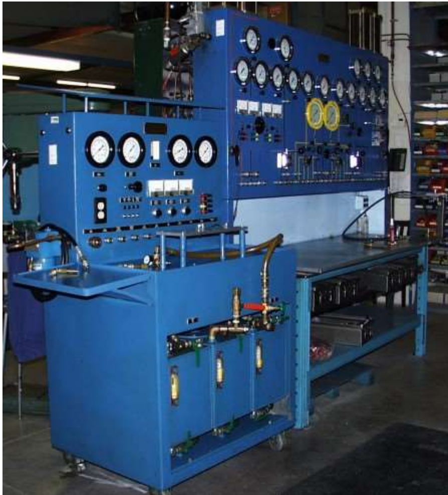
slika 17. oprema za pneumatski test ( www.pmc-controls.com )
