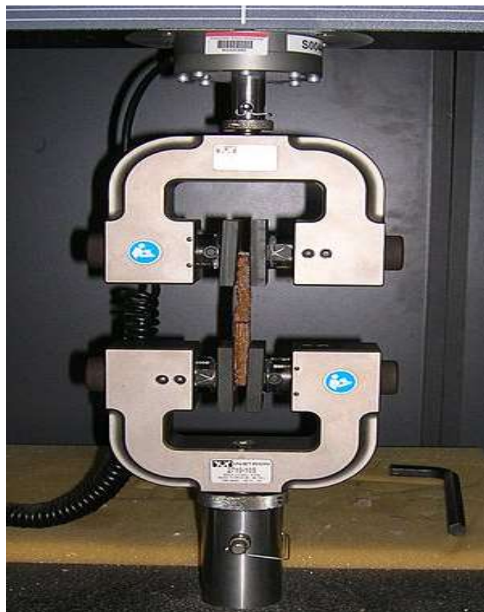
slika 4. univerzalna kidalica ( www.cmk.vuka.hr )
