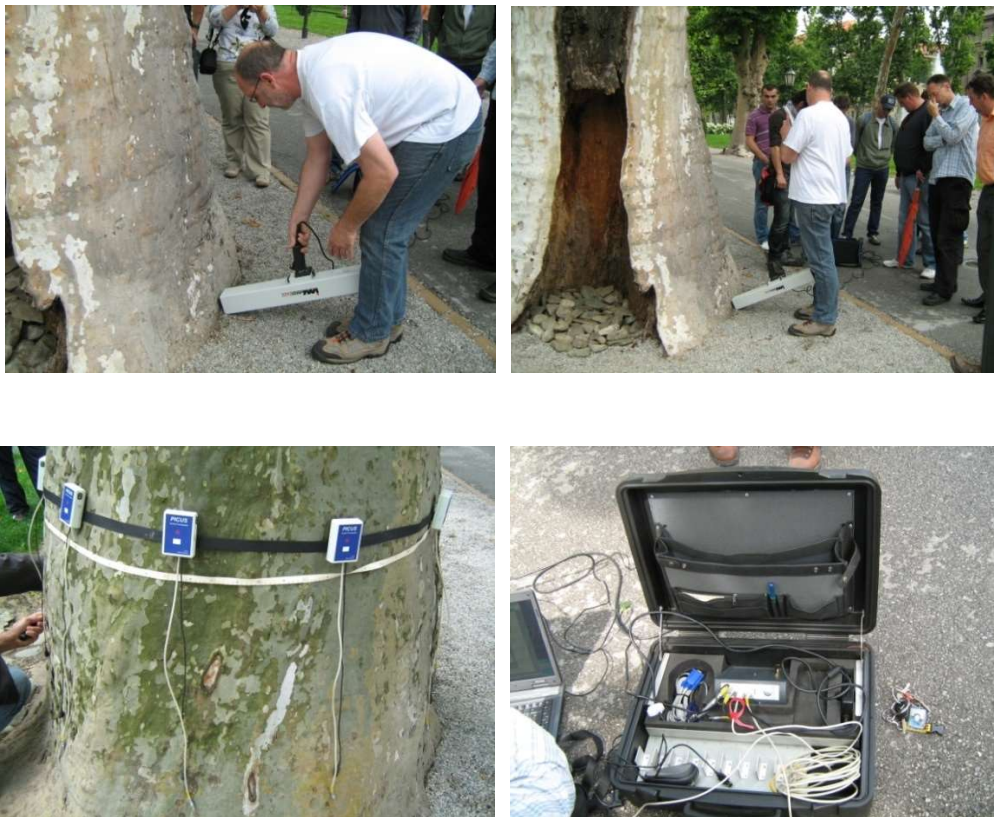
Slika 33., 34., 35. i 36.: Dijagnostički pregled sonarnim tomografom za statiku stabala
