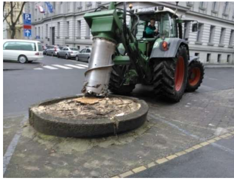
Slika19.: Strojno vađenje panja i priprema rupe za sadnju
