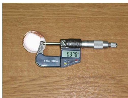
Slika 11. Mjerenje debljine ljuske kokošnjeg
