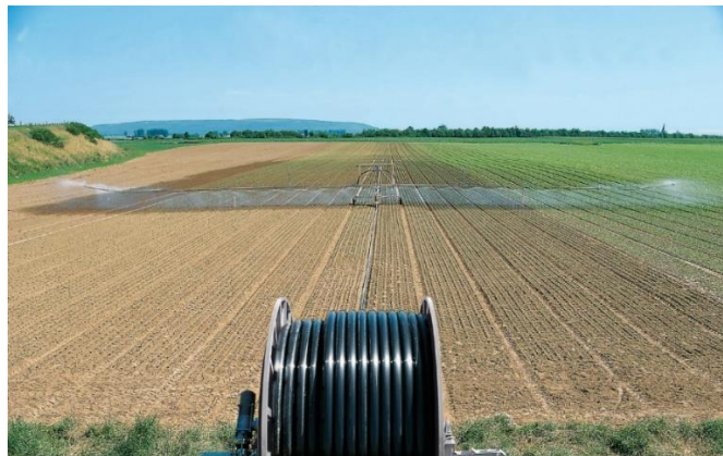
Slika 6. Kišno krilo i kotur (Preuzeto sa: www.bauer.com )
