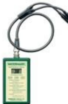
Slika 4. Watermark uređaj za mjerenje vodnoga potencijala tla (Preuzeto sa: http://www.irrometer.com/sensors.html )
