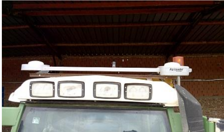
Slika 33. GPS antena montirana na krov traktora
