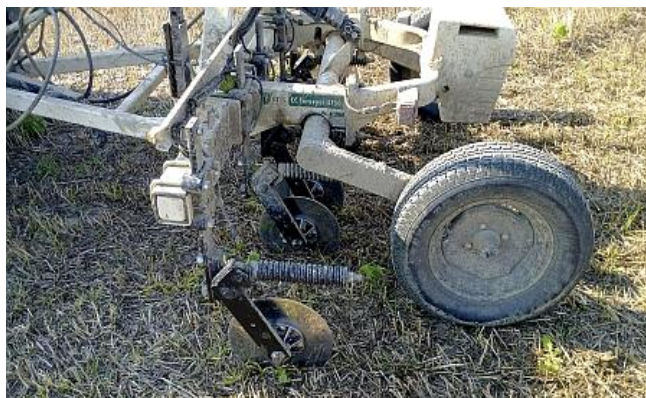
Slika 16. Skener elektrovodljivosti tla Veris EC Surveyor 3150
