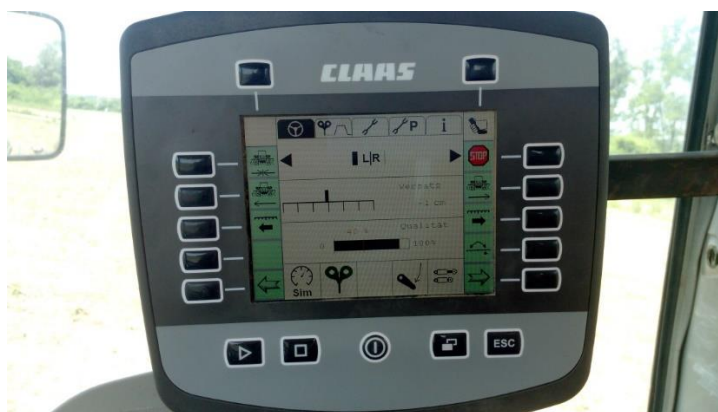
Slika 11. Monitor za nadzor kultivatora
