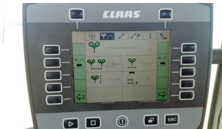
Slika 12. Podešavanje parametara kamere na monitoru
