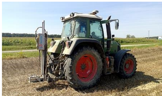
Slika 21. Uzimanje uzoraka tla sondom Nietfeld Duoprob montiranom na traktor Fendt412 (vlastiti izvor)
