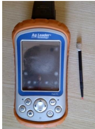
Slika 20. Ag Leader ručno računalo s montiranim GPS prijemnikom Wintec G-Rays I (vlastiti izvor)
