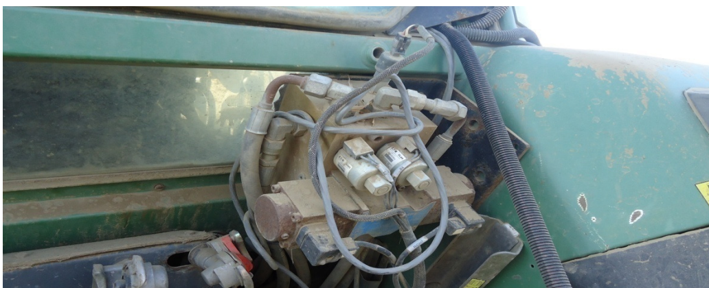
Slika 54. Hidraulički blok za automatsko upravljanje.
