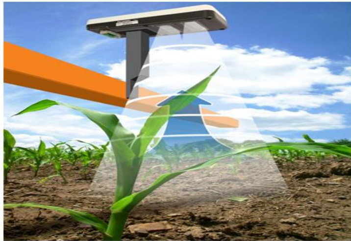
Slika 17. "OptRx" sustav za mjerenje refleksije biljke.
