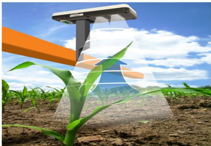
Slika 17. "OptRx" sustav za mjerenje refleksije biljke.
