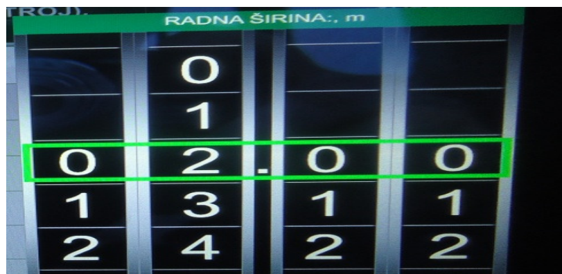
Slika 31. Postavljanje širine radnog zahvata.
