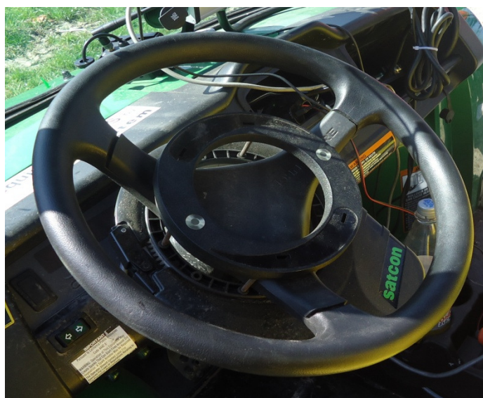
Slika 39. Sustav za automatsko upravljanje.
