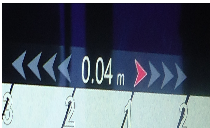
Slika 36. Traka s informacijama o količini odstupanja od idealne putanje.
