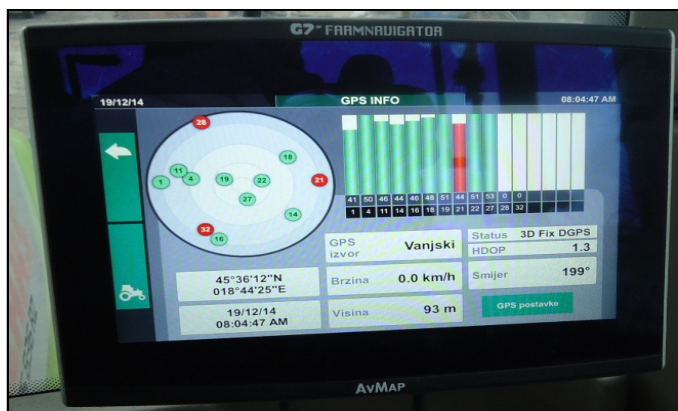
Slika 26. Prikaz stanja GPS satelita.
