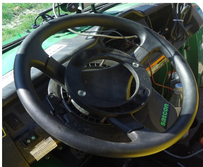
Slika 39. Sustav za automatsko upravljanje.
