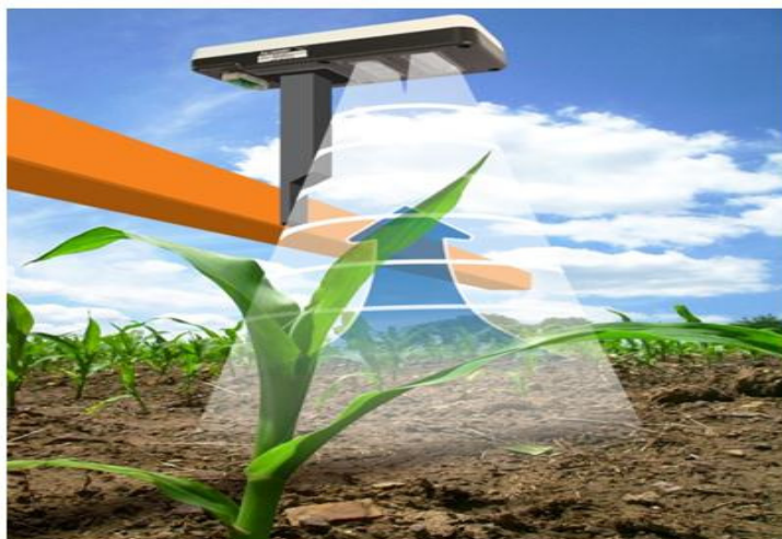
Slika 17. "OptRx" sustav za mjerenje refleksije biljke.
