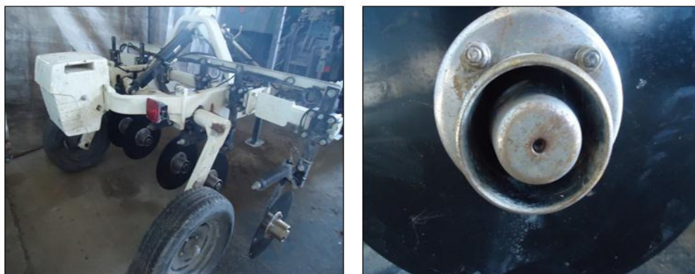
Slika 42. "Ec Surveyor 3150" (lijevo) i disk sa senzorom (desno).
