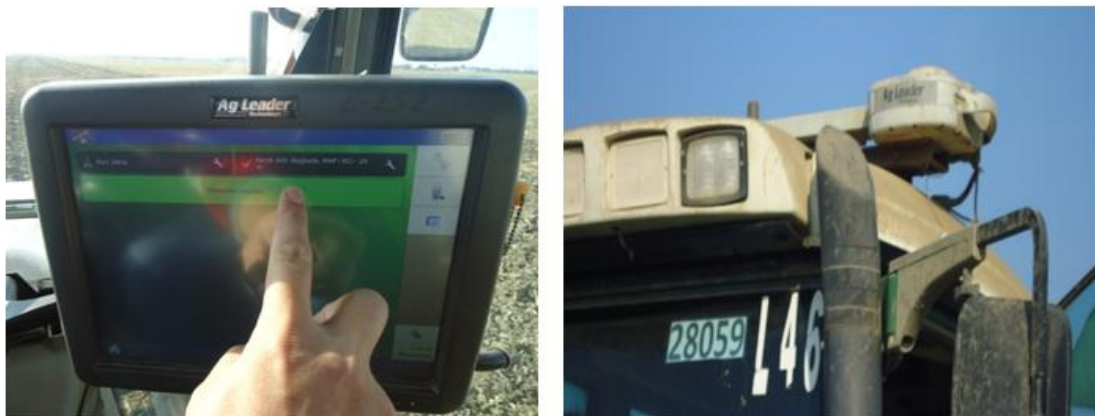
Slika 53. Zaslon "Ag Leader INTEGRA" ( lijevo) i antena "Paradyne" (desno).
