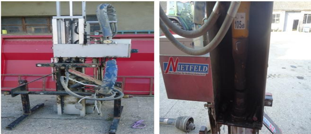
Slika 44. "Duoprobe 60" (lijevo) i izgled pneumatskog čekića (desno).
