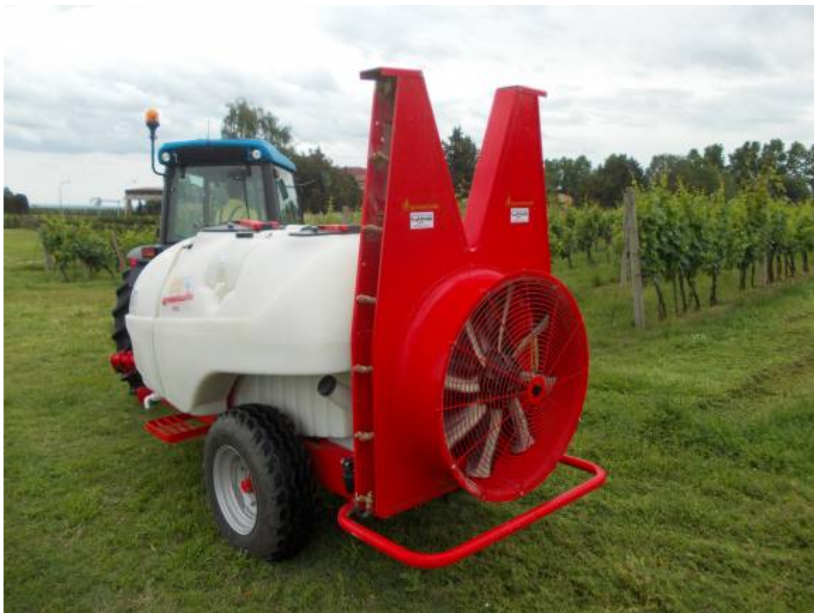
Slika 8. Vučeni traktorski raspršivač AGP 2000 EN .
