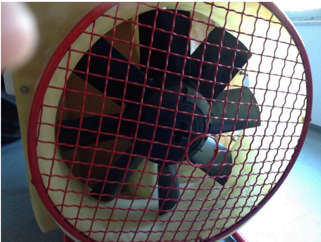
Slika 12. Aksijalni ventilator raspršivača Agromehanika 500 AN
