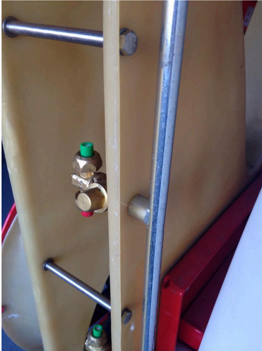
Slika 11. Mlaznica raspršivača Agromehanika 500 EN
